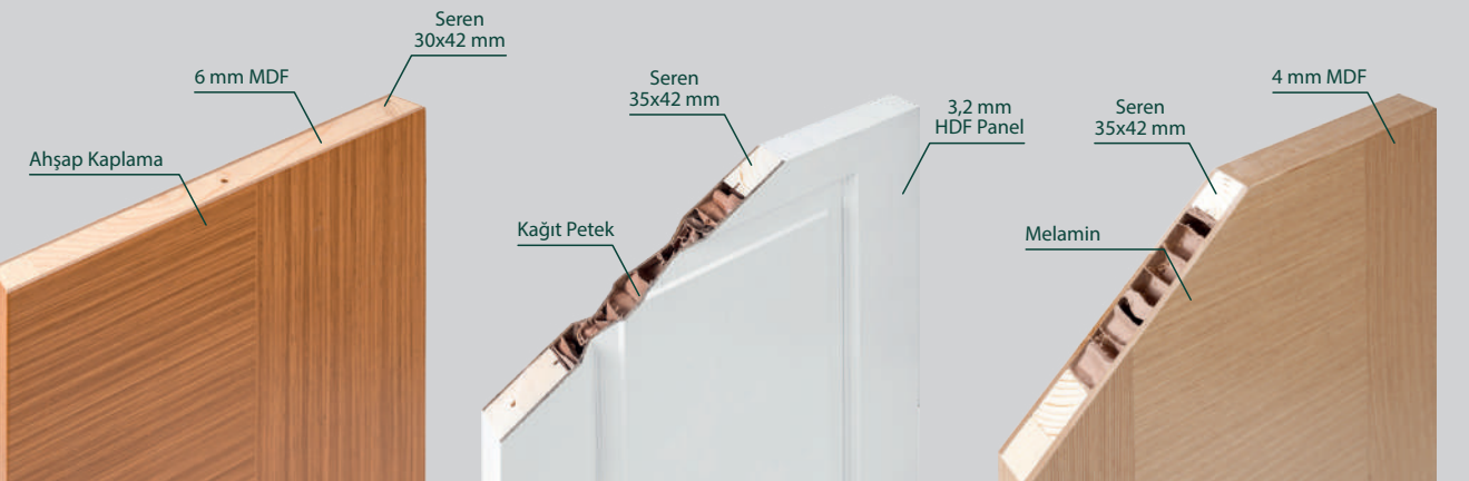
Ahşap Kanat Kesiti
